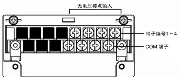
€继电器报警输出(2点c接点)+无电压接点输入(2点)
