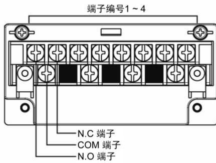
€无电压接点输入(4点)
