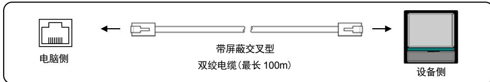
② 电脑与集线器、以太网设备之间的连接示例(1对N连接)
