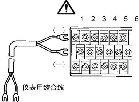
直流电压输入(电流输入时在(+) (-)间并联联接 250 $\Omega$  受信电阻)
