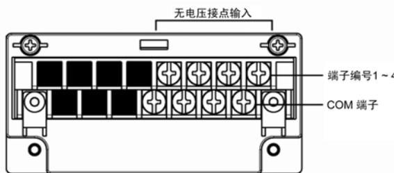
· 继电器报警输出(2点 c 接点)+无电压接点输入(2点)
