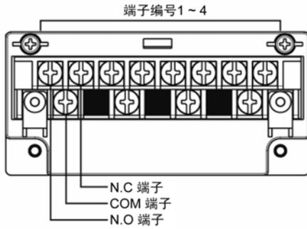
· 无电压接点输入(4点)
