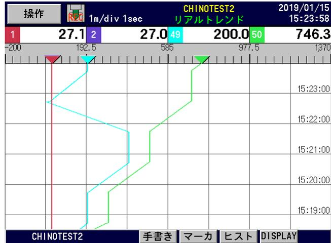
(例)CH1, CH2 为实际输入通道、CH49, CH50 为基准文件数据的再生
