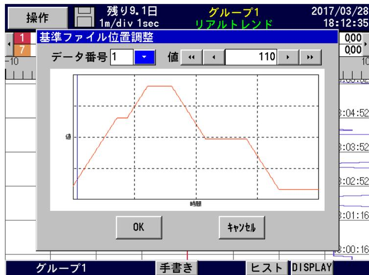
将再生位置返回初始位置时，也可以通过[累计复位]进行。进行累计复位后，基准文件的内容被清除，返回到文件初始位置进行再生。累计复位的设定请通过[操作]—[MENU 设定]进行。
