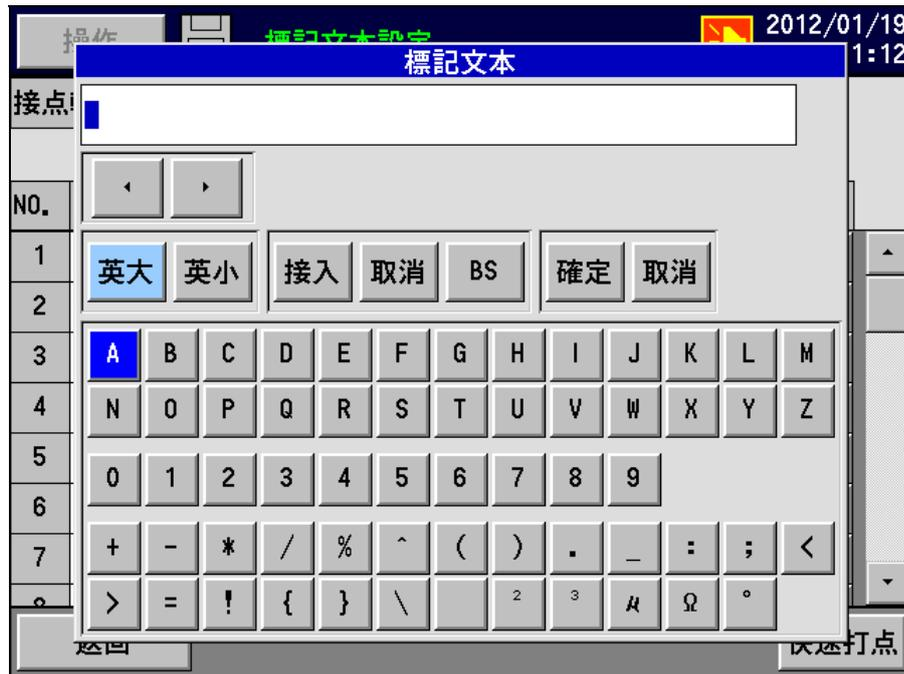
显示字符输入画面后，单击英大或英小等后，位于下栏的键对应地切换显示画面。请单击所需输入的字符。字符显示栏显示所选字符。单击字符显示栏的字符部分后光标移动，可将字符插入(或覆盖)到光标位置。
