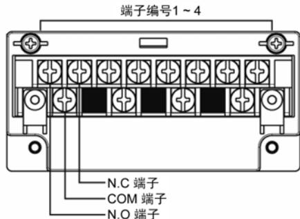
· 无电压接点输入(4 点)
