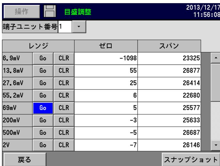
②弹出指示输入电压值的窗口后，请将该值输入本仪表。
