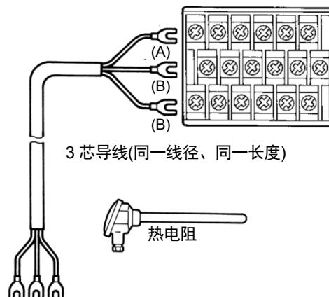
※每根芯线的电阻值为10Ω以下。3根芯线的电阻值相同。
