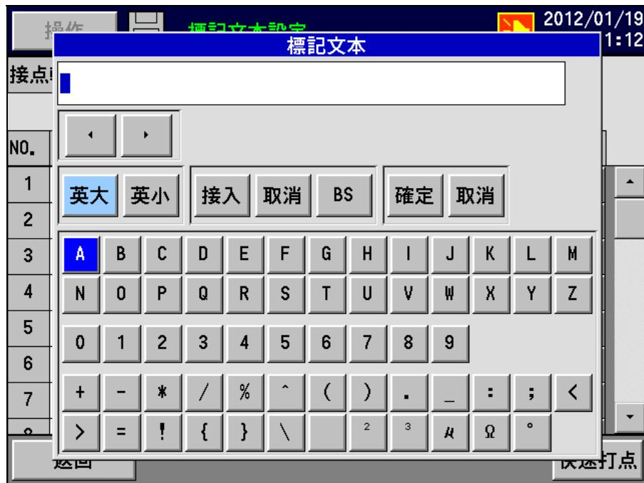
显示字符输入画面后，单击英大或英小等后，位于下栏的键对应地切换显示画面。请单击所需输入的字符。
