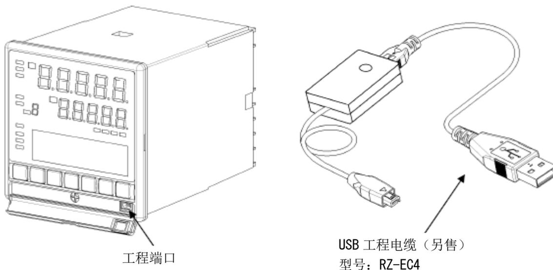
工程端口因其结构上的原因，只能用于临时的通信连接，不能用于经常性的连接。若要经常连接进行通信，则在购买时，请指定带通信接口规格，它能长久连接在后面端子上使用。
