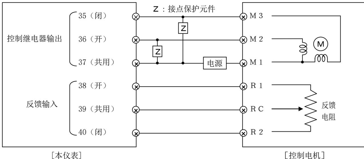
上图中为仪表和本公司产控制电机直接接线，但实际接线必须通过缓冲继电器连接。
